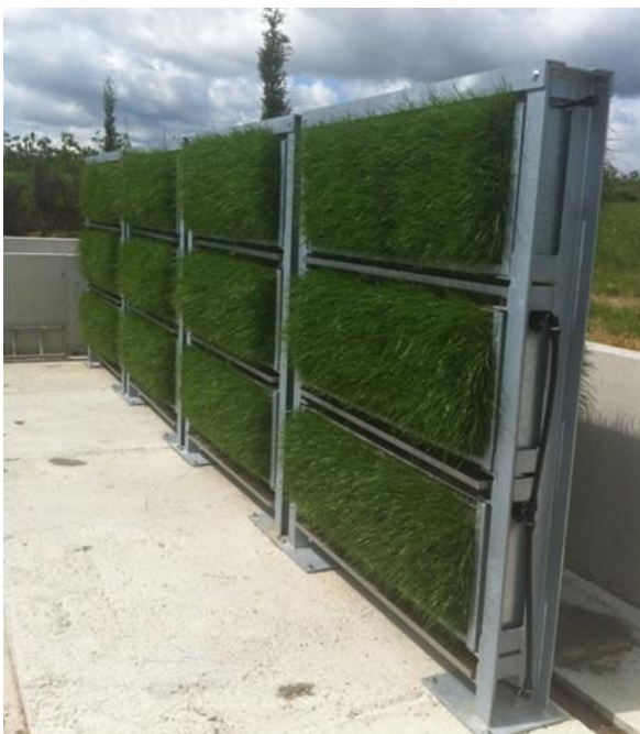
Figur 10. VerticalGreen Biobed från Schweiz. Anläggningen består av stål nätburar, fyllda med biomix. På yttersidorna etableras gräs. Vätskan rinner genom biomixen i burarna och samlas upp i en tank, för att sedan spridas över den översta, så länge det finns vätska kvar.
