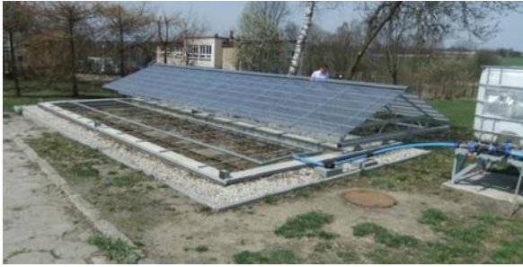
Figur 7. Större PhytoBac i Polen. Bioreaktorn är försedd med plasttak som går att skjuta åt sidan vid urgrävning/påfyllning av biomix.
