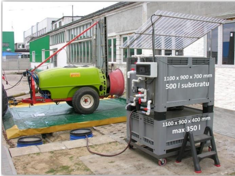
Figur 9. Bioreaktorn VertiBac, bestående av två behållare, 350 + 500 liter. I den övre finns biomixen. Den undre samlar upp den dränerade vätskan. Vätskan pumpas upp och sprids därefter åter över biomixen (Doruchowski et al., 2012; Doruchowski, pers. medd., 2012, 2013).
