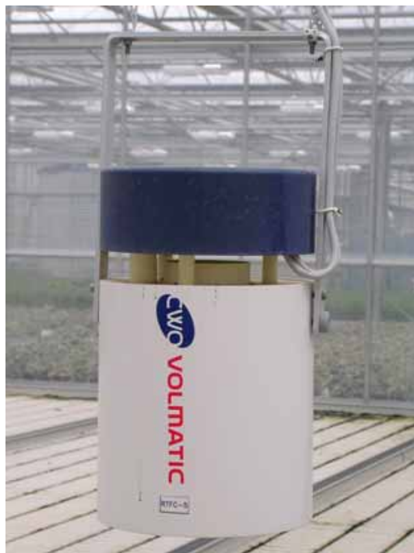
Figur 39. Temperatur- och luftfuktighetsgivare från DGT-Volmatic. Själva givarkropparna sitter inne i lådan, vilket är viktigt för att förhindra att solstrålningen ska påverka mätningen. Inne i lådan sitter en fläkt för att byta ut luften.
