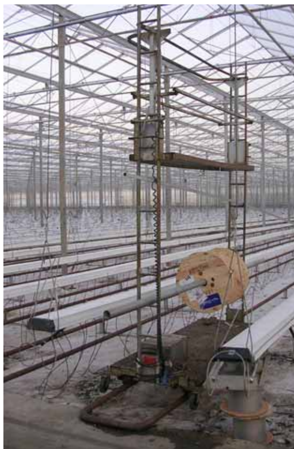
Figur 37. Vagn för tomatodling och andra kulturer som drivs framåt av batteri.
