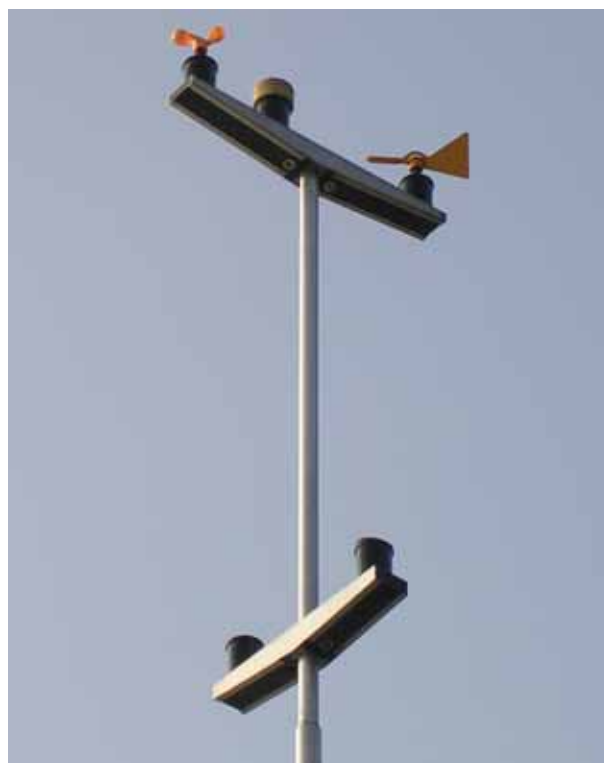
Figur 41. Priva väderstation, med givare för ljus och regn (nederst) och vindriktning, vindhastighet och temperatur (överst).
