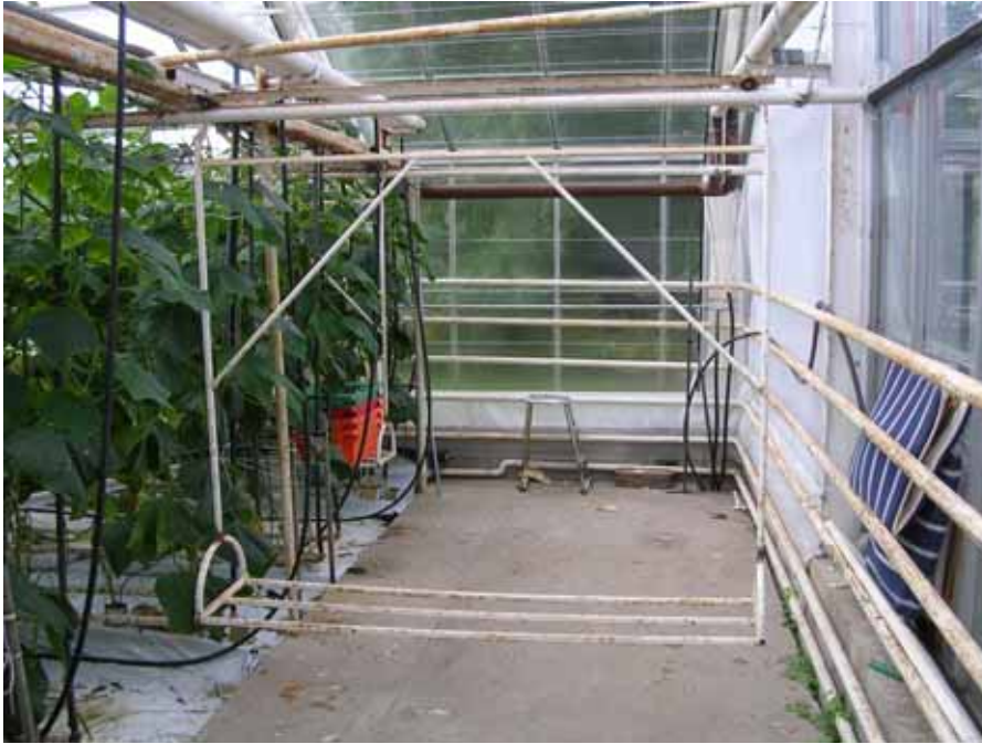
Figur 38. Hemmabyggt vagn som rullar på rör i taket. Vagnen kan användas i alla typer av odling både grönsaker och prydnadsväxter.
